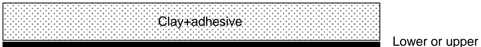
(d) adhesive-bound clay to geomembrane
